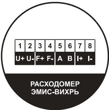
Рисунок Б.1 - Расположение зажимов клеммной колодки
